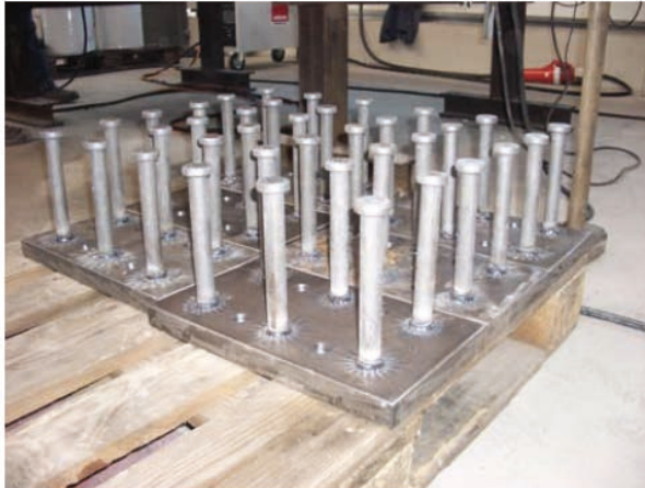
Bild 14: Ankerplatten mit aufgeschweißten KÖCO-Kopfbolzen in der Fertigung
