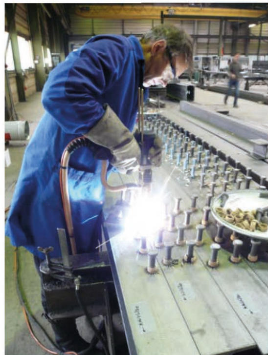
Bild 4: Bolzenschweißen in der Serienfertigung von Verbundträgern
