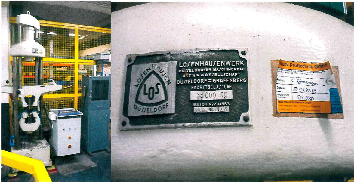
Abb. 4 und 5: Zugmaschine mit Prüfplakette
